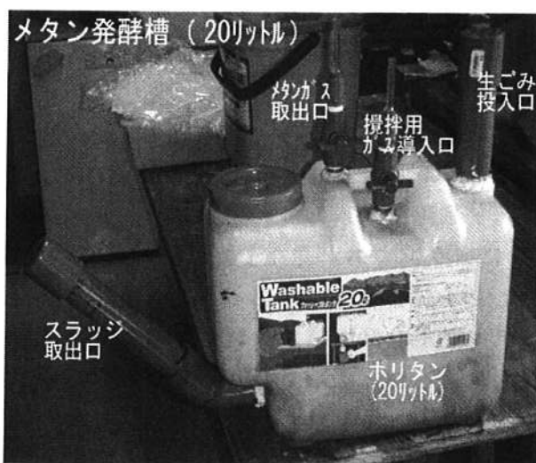
図 2-1-23 浮蓋式メタン発酵槽
