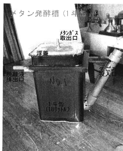
図 2-1-24 密閉式メタン発酵槽
